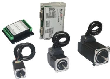
ISTEP 系列闭环步进伺服系统由装配有高分辨率增量编码器的PK系列混合式步进电机与IDM系列可编程伺服驱动器组成，完全以伺服控制方法控制步进电机的位置、速度、转矩。通过高级可编程软件EZ-Motion/Setup或C++/VC/VB/Delphi/LabView运动函数库，能在同一软件平台上为脱离主机运行(Stand-alone)或分布式网络运动控制应用提供一个高度灵活、多功能、简单配置、图形化运动控制编程的理想解决方案。
